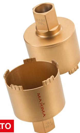
È l'utensile della gamma idoneo a consentire lavorazioni che richiedano l'aspirazione delle polveri. Anche il **Foretto Aspirazione 70** monta lo stesso segmento diamantato dei foretti lunghi 150 mm e perciò è in grado di **forare a secco materiali come cemento armato**, laterizi, tegole e calcestruzzo. La lunghezza utile di 70 mm nasce dall'esigenza di effettuare fori per le scatole dell'elettricità, necessità avvertita soprattutto nei mercati export.
